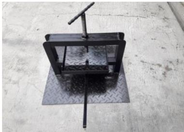
Gambar. 1. Alat press untuk membuat panel akustik
