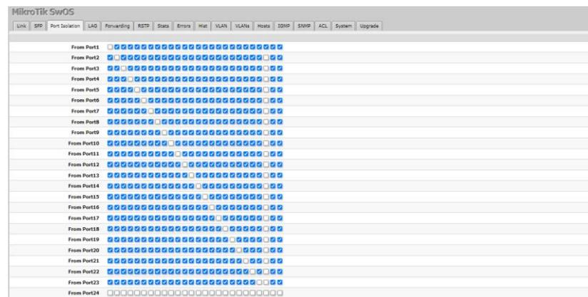
**Gambar 4.** Hasil Konfigurasi *Isolation 1 Port*
