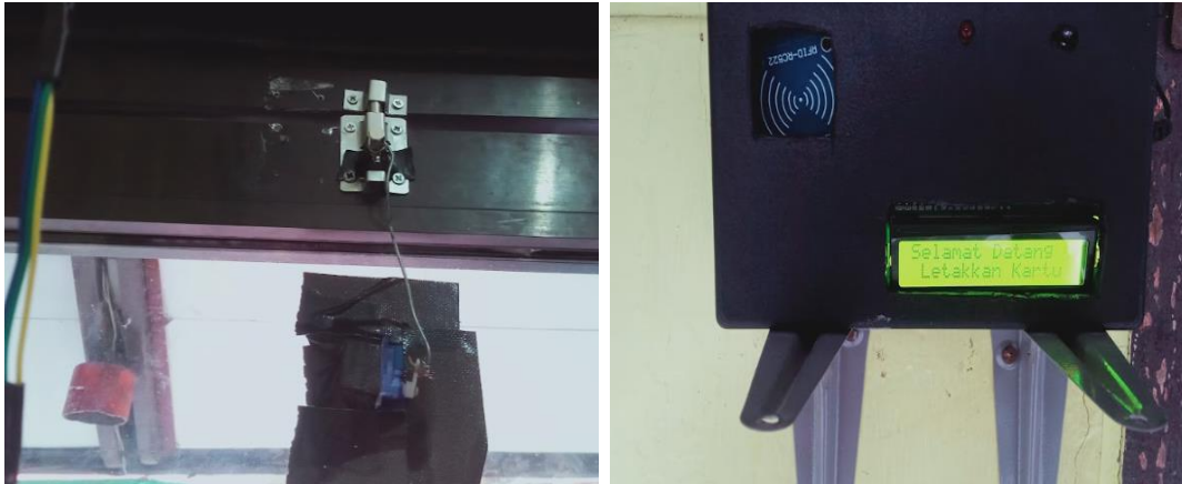
Gambar 2. Penempatan Motor Pengerak dan Alat Pintu Otomatis
