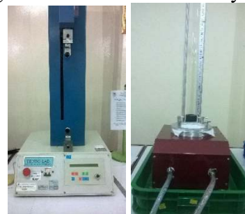
Gambar 7. Alat uji kekuatan Tarik dan Daya Tembus Air
