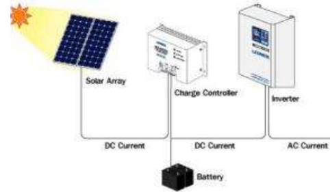
Gambar 6. Sistem Energi Surya Fotovoltaik Sumber: Widayana, 2012
