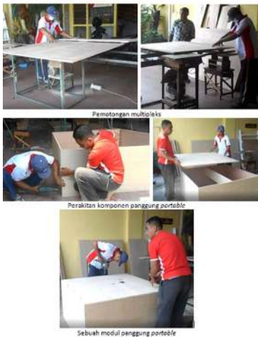
Gambar 9. Pembuatan Panggung Portable (2 minggu)
