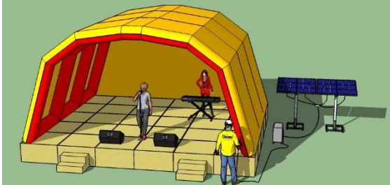
Gambar 8. Desain Atap Panggung Struktur Pneumatik Tium Energi Surya
