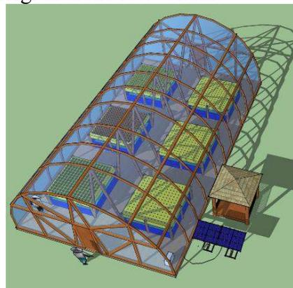
Gambar 3. Desain *Greenhouse* bambu untuk pertanian hidroganik energi surya (15 hari)
