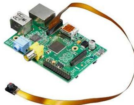
Gambar 6. Raspberry Pi dengan mini kamera.
