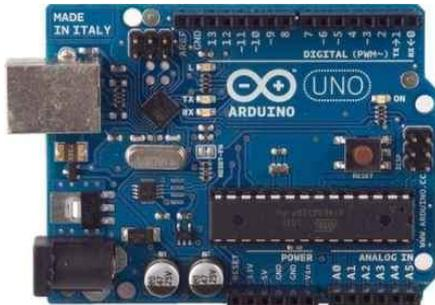
**Gambar 7.** Mikrokontroler arduino uno.
