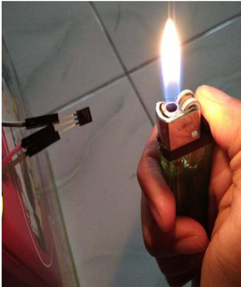
Gambar 7 Pengujian sensor LM-35
