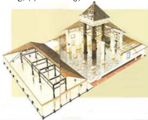
Gambar 3a. Tipologi bentuk dan struktur Masjid Jawa, seperti pada Masjid Demak, Sumber : Groiler International, 2002
