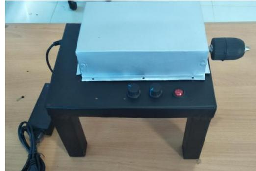
Gambar 10. Mesin penggulung benang
