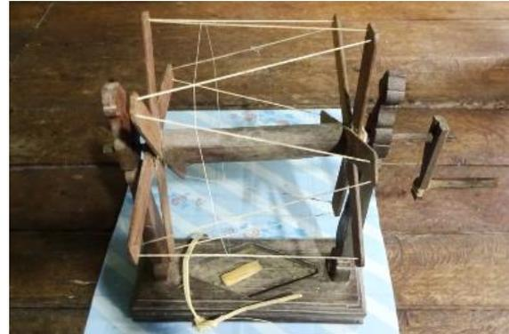
Gambar 2. Terauan, alat penggulung benang tenun
