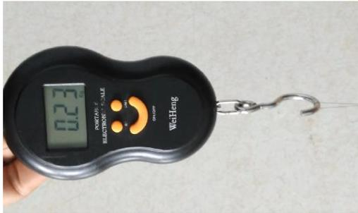
Gambar 8. Pengukuran kekuatan tarik benang
