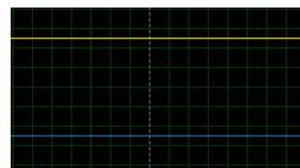
Gambar 18. Sinyal PWM Motor Kanan & Motor Kiri sama dengan 100%
